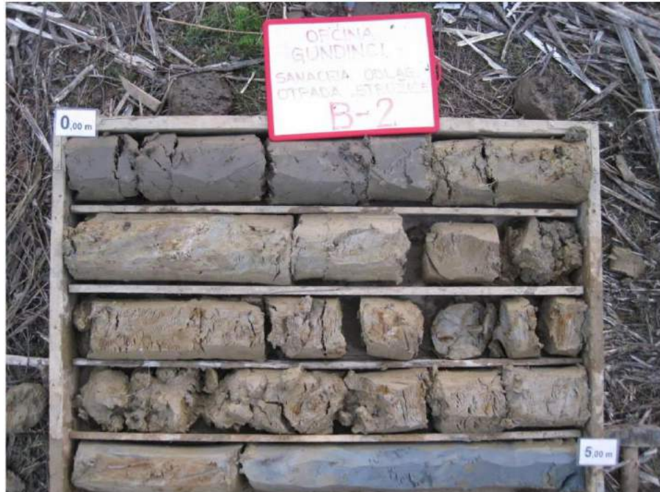
Slika 2.1.2-5. Jezgra iz istražne bušotine B-2 (0,00 - 5,00 m), slika preuzeta iz Geotehničkog elaborata, (INSTITUT IGH, d.d., ožujak 2017.)
