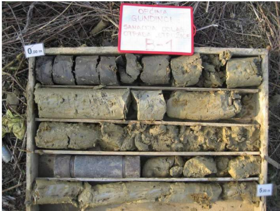
Slika 2.1.2-4. Jezgra iz istražne bušotine B-1 (0,00 - 5,00 m ), slika preuzeta iz Geotehničkog elaborata, (INSTITUT IGH, d.d., ožujak 2017.)
